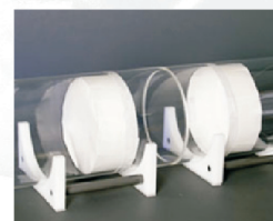
Repetir el paso 2, insertar y pegar la presa en la tubería contraria.
