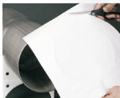
Cortar el papel en un circulo con un Ø 1 a 3 cm mas del Ø interno de la tuberia
